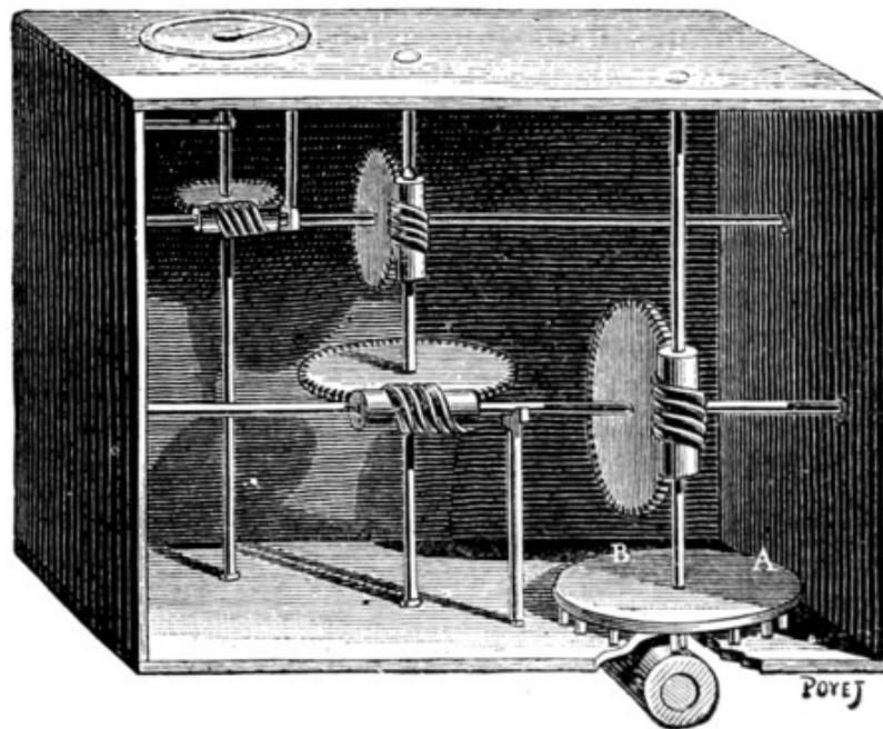
FIG. 1.—HERON'S ODOMETER FOR VEHICLES.
