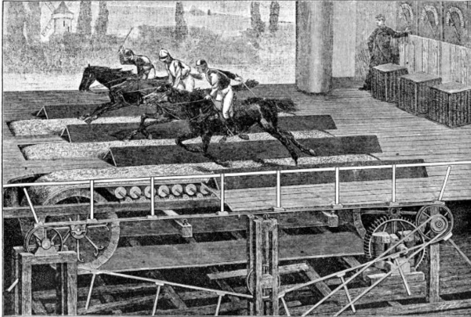
HORSE RACING ON THE STAGE—MACHINERY UNDER THE STAGE FOR DRIVING THE ENDLESS BELT.
