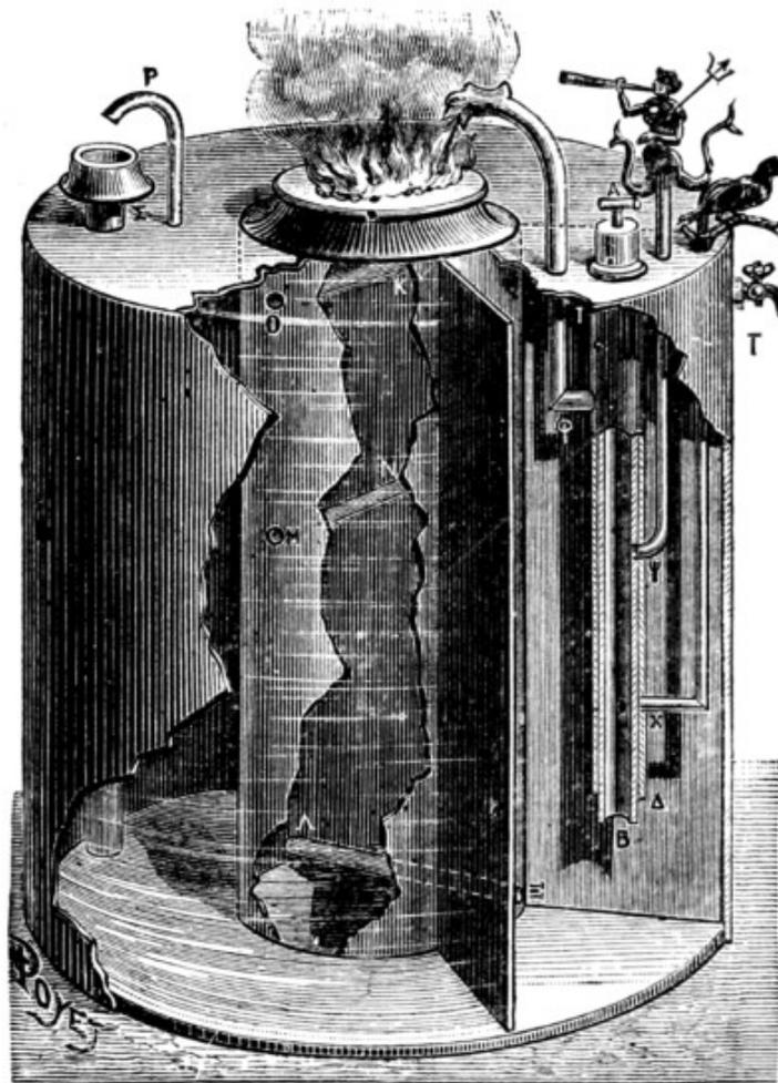
FIG. 4.—HERON'S TUBULAR BOILER.
